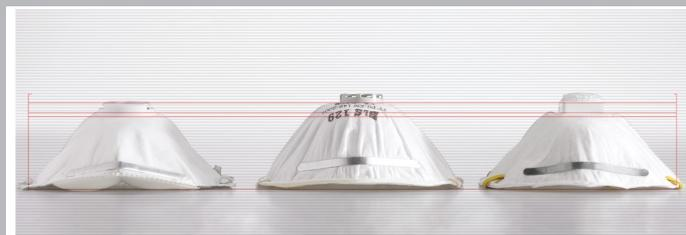
La mascarilla pasa el ensayo de colmatación con polvo de Dolomita. Baja resistencia y mayor duración
