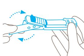
Retire la hoja, gírela (para zurdos) o cámbiela. Asegúrese de volver a colocar la hoja **justo en la leva**.
