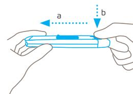
Cierre la cubierta de la hoja y coloque de nuevo el inserto de plástico en el mango. Finalmente, **presione hacia abajo** el pulsador para cambio de hoja.
