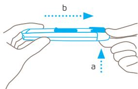
Presione el pulsador para cambio de hoja **de abajo arriba** y tire del inserto de plástico hacia atrás con el mango.
