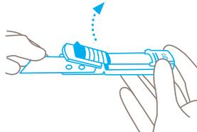
Coger la cuchilla por el lado **romo** y utilizarla para abrir la cubierta de la hoja. La cubierta se queda en posición abierta.
