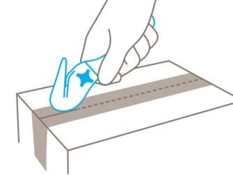
Para emplear el rasgador de cinta adhesiva, gire la herramienta de corte 180 grados.
