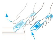
Retirar los pulgares para un alto grado de seguridad. Tan pronto como comience a cortar, retire el pulgar del desplazador y la hoja desaparecerá dentro del mango en el momento que pierda contacto con el material a cortar.
