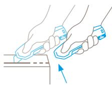
La herramienta de corte inteligente: tan pronto como la hoja abandona el material que está cortando, se retrae automáticamente dentro del mango. Incluso si usted mantiene presionado el desplazador o el mango. Esto es lo que llamamos "un muy alto grado de seguridad".
