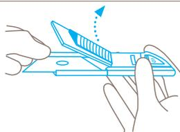
Coger la cuchilla por el lado **romo** y utilizarla para abrir la cubierta de la hoja. La cubierta se queda en posición abierta.
