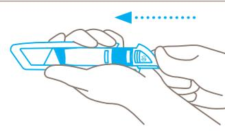
Cerrar la cubierta de la hoja e insertar la pieza de plástico de nuevo en el mango hasta que se **oiga** que el botón de cambio de hoja encaje.
