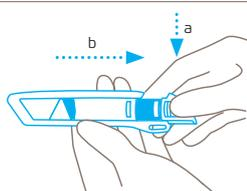
**Pulse** el botón de cambio de hoja y saque la pieza de plástico del mango desplazándola hacia atrás.
